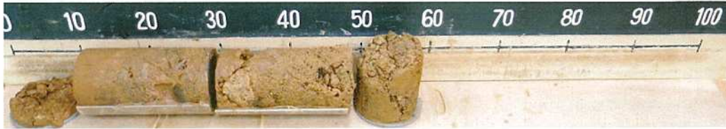
写真3 トリプルサンプリング 粘性土質砂質礫
