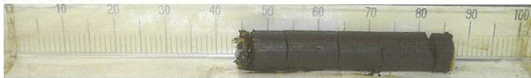
写真2 シンウォールサンプリング 砂質シルト
