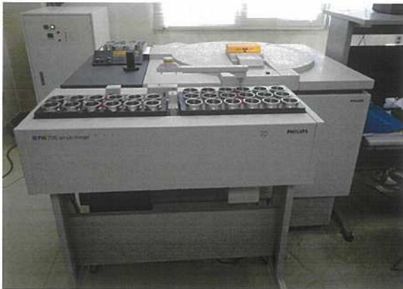
写真1 波長分散型蛍光X線分析装置(XRF) パナリティカル社(旧フィリップス社)製 MagiX
