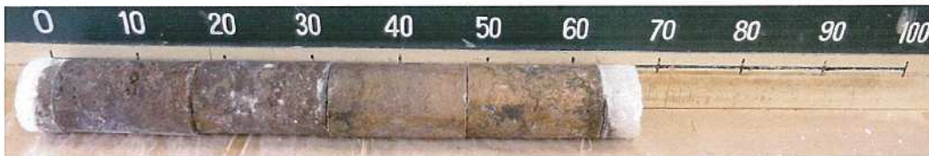
写真4 トリプルサンプリング 火山灰質砂・礫
