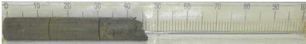
写真1 シンウォールサンプリング 粘性土
