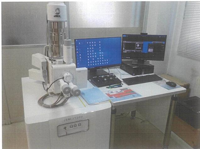
写真1 エネルギー分散型X線分析装置(EDS)を付設する走査電子顕微鏡装置(SEM)
