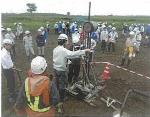
機械式コーン貫入試験
