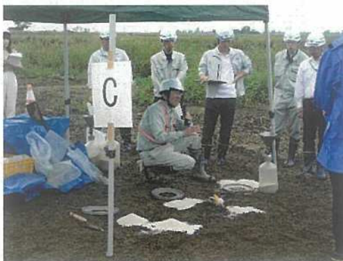
現場密度試験
