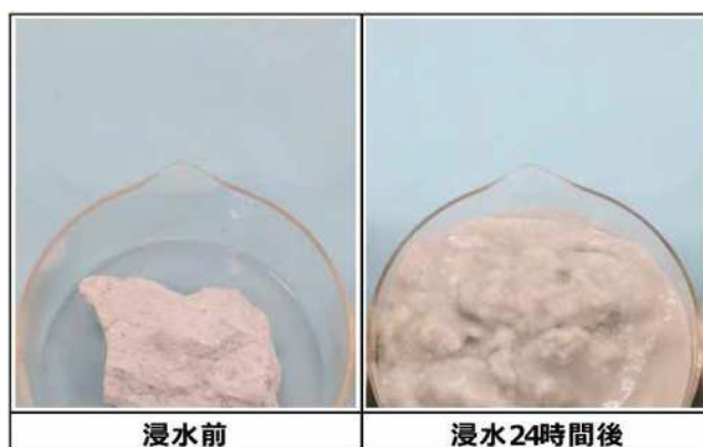
写真-2 スメクタイトを顕著に含む岩石試料の浸水前と24時間後の挙動
