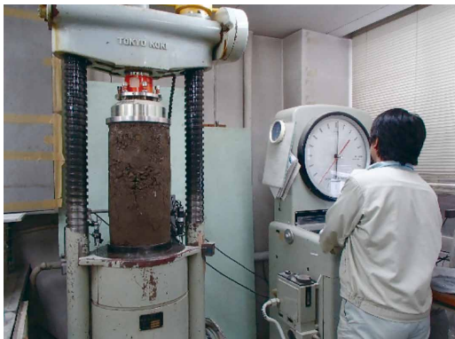
写真-5 コンクリート圧縮試験中
